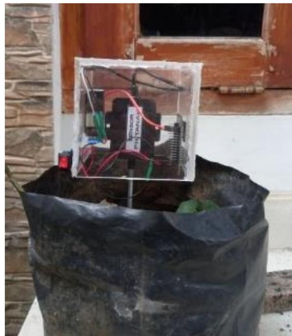
**Gambar 5.** Penancapan Alat Pengukur pH Pada Lahan
