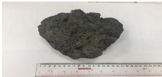
**Gambar 1.** Bongkahan *Slag steel* mentah.
