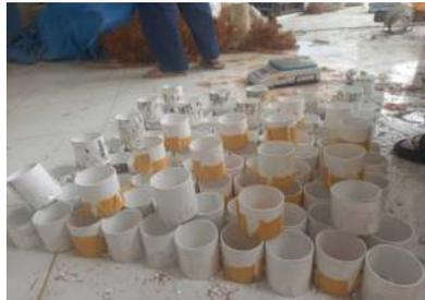
**Gambar 8.** Cetakan Silinde Pipa PVC
