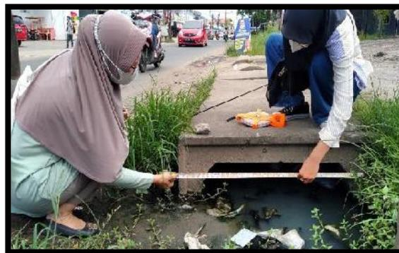
**Gambar 3.2** Pengukuran Dimensi Saluran *Existing* Drainase
