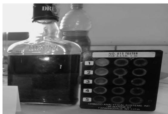
**Gambar 4.1** Hasil Pengujian Kadar Organik Agregat Halus
