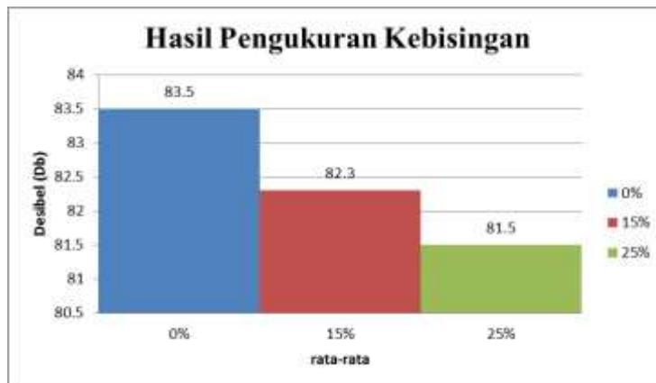
**Gambar 3.** Pengukuran intensitas kebisingan menggunakan batu bata campuran serbuk sengon
