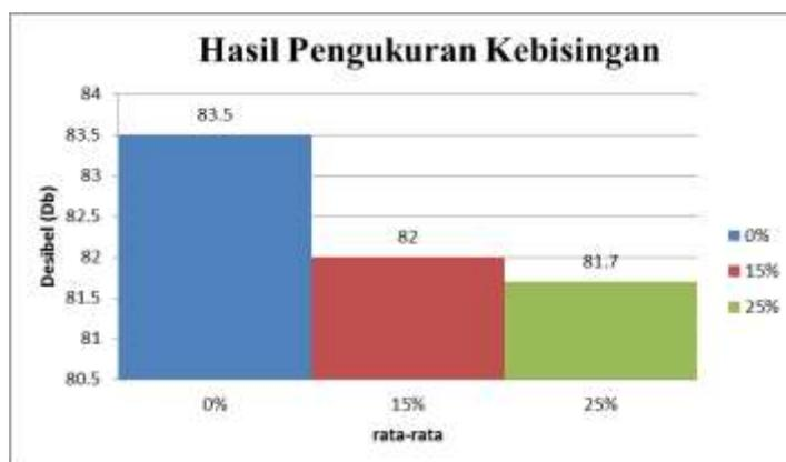
**Gambar 6.** Pengukuran intensitas kebisingan menggunakan batu bata campuran serbuk kelapa
