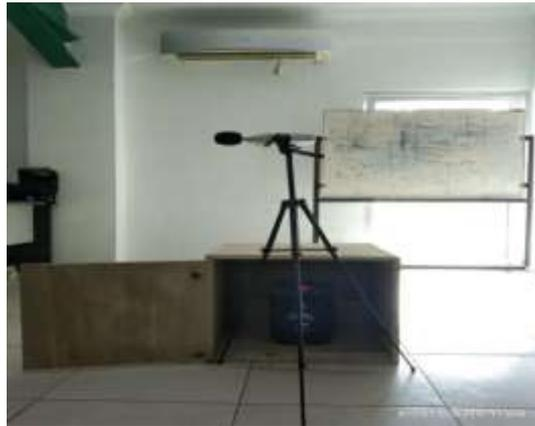
**Gambar 2.** Pengukuran intensitas kebisingan bata tanpa menggunakan batu bata (kontrol)
