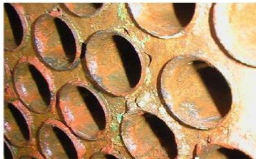
**Gambar 6.** Kerusakan pada *Tube* Kondensor
