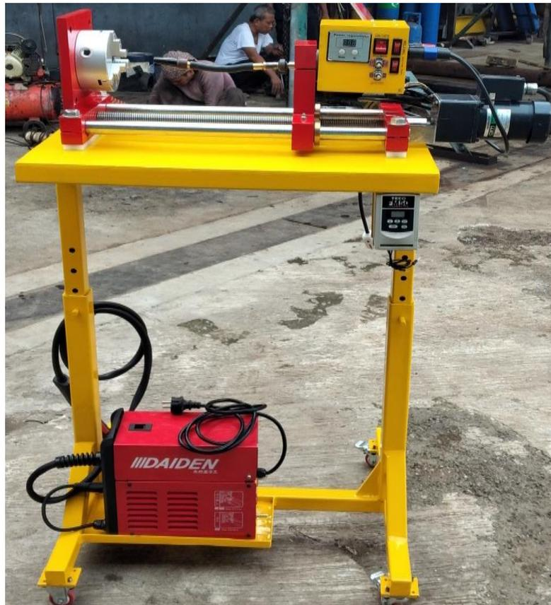
**Gambar 2.** Hasil Perancangan Ulang Mesin Las
