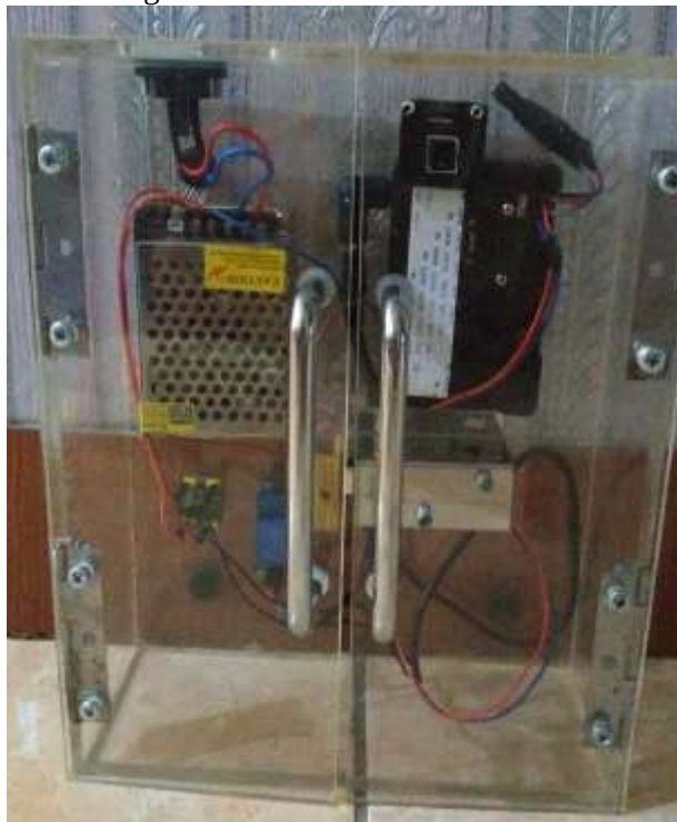
Gambar 7. Purwarupa sistem keamanan kunci pintu
