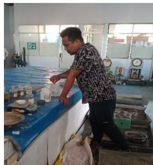
Gambar 6. Pengujian kadar organik pada bahan
