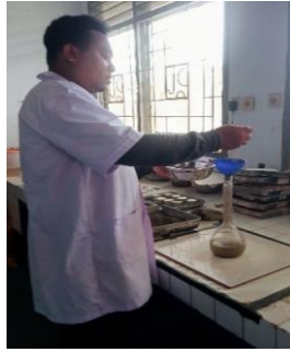
Gambar 7. Pemeriksaan spesifik dan penyerapan air agregat halus
