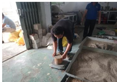
Gambar 2. Pemeriksaan bobot isi padat dan rongga udara
