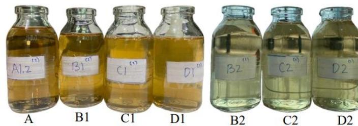
**Gambar 2.** Warna Air Gambut Setelah Proses *Jar test*
